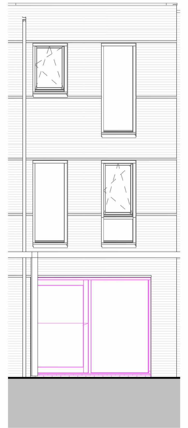
A3-201: bredere schuifpui achtergevel circa 3,1m
